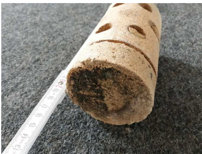
SchwarzAnstrich Wand Süd zwischen K+S und Klinker
