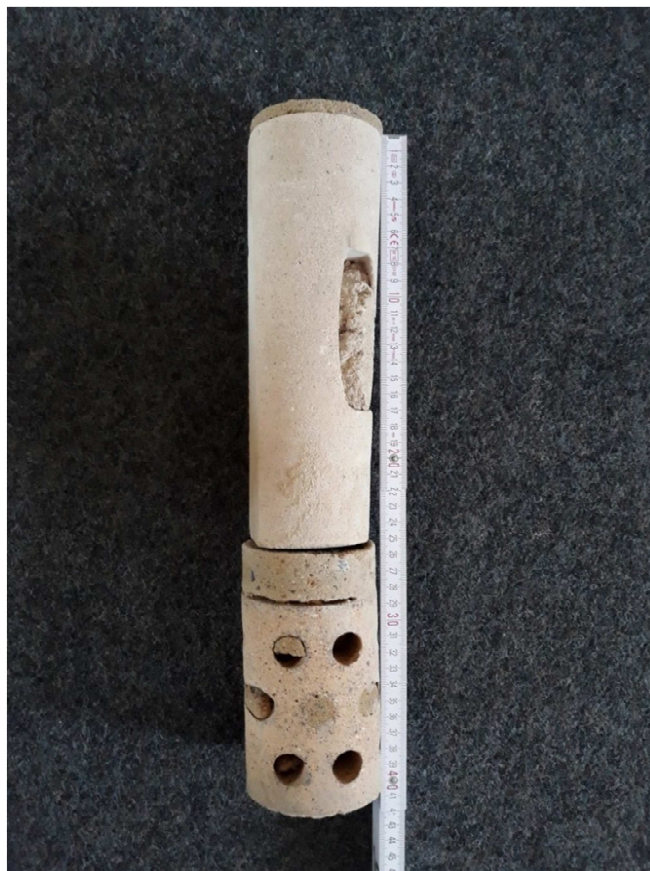
Bohrkern Wand Süd
